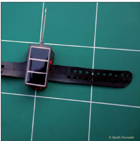
Figure 1. - Balise montée sur un collier
